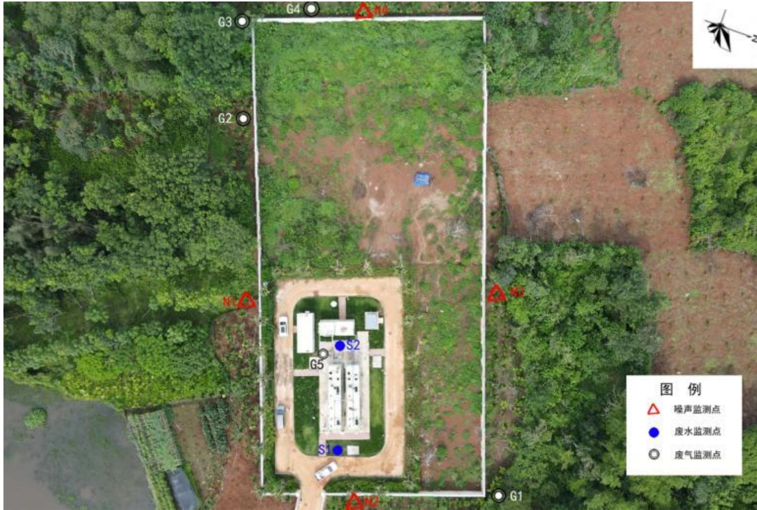
附图1 项目噪声、废水和废气环境监测点
